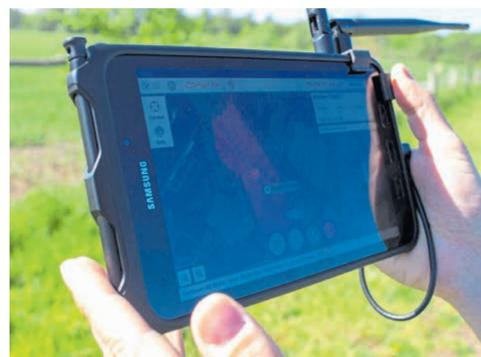
Das Tablet plant und überwacht die Flüge. Dabei werden Telemetriedaten, zum Beispiel Flughöhe und Kurs, per Funk übertragen.
